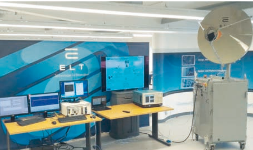
Labor: T&E Produkte von ELT für laborgebundene Tests und Validierungen mit angeschlossenen Echtsystemen über HW-in-the-loop (HIL) Verfahren.
